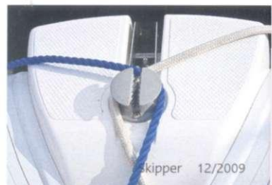
Praktisch ist der eingeklebte Bugspriet aus GFK
